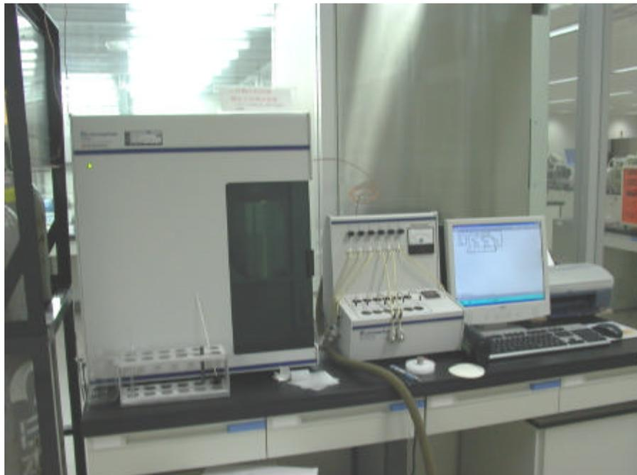
3つのポートを持ち、最大3サンプルまでを同時分析することのできる、自動ガス吸着装置です。第2ポートをジェミニ法に準拠してフリースペース測定に使用したり、第3ポートを飽和蒸気圧の連続測定に使用したりすることもできます。
