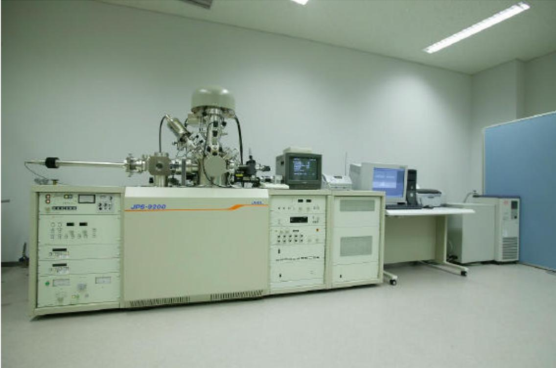
X線を材料表面に照射することにより、材料の最表面（深さ1～10ナノメートル）の化学結合状態についての情報を得ることができる装置です。薄層における化学結合状態の観察ができます。
